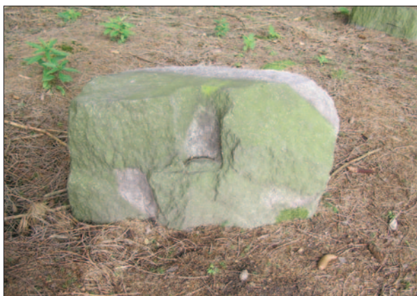
Obr. 6. Orlík u Humpolce. Polovina rozpracovaného mlýnského kamene č. 3 prasklého při vrtání
