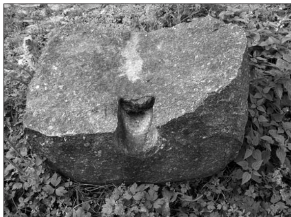
Obr. 10. Kašperské Hory. Mlýnský kámen rozlomený při vrtání dutým vrtákem. Obr. 2–7 a 10 foto J. Fröhlich
