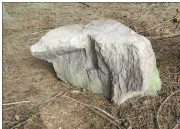
Obr. 7. Orlík u Humpolce. Druhá polovina rozpracovaného mlýnského kamene č. 3 prasklého při vrtání
